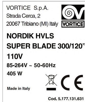
Fig. 1 - Beispiel Typenschild für SUPERBLADE 300/120" 110V
